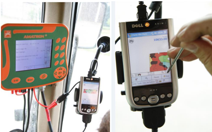
Abb. 5) Ansteuerung des Düngerstreuers mit Pocket-PC und Software „Farm Site Mate“ von Farmworks
